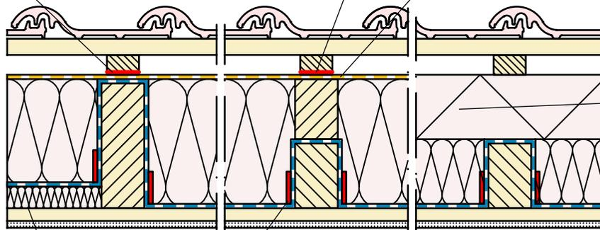
Montageleiste für Sparrenflanke DASATOP FIX
